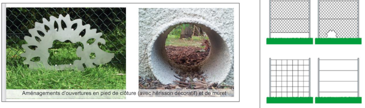
Figure 7. Ouverture de passages sur clôtures et murets -à gauche- et types de grillage adaptés à la circulation de la petite et moyenne faune -à droite- (Sources : urbanisme-bati-biodiversite.fr et 1001sitesnatureenville.ch )
